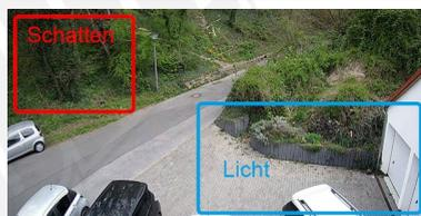
Mit der Funktion Wide Dynamic kommen Details sowohl in dunklen als auch in hellen Bildbereichen besser zur Geltung. Dadurch, dass die einzelnen Objektbereiche in einer Szene von der Kamera digital mit unterschiedlichen Helligkeits- beziehungsweise Gammawerten versehen werden, sind die Objekte in den hellen sowie in den dunklen Bereichen gut sichtbar.
