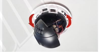
Setzen Sie die Haube wieder auf die Kamera und drehen Sie die Haube in Pfeilrichtung, bis sie einrastet.
